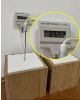
Рисунок 2 – Определение тепловыделения в модельных системах в термоизолированных ячейках
